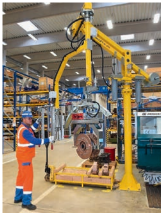
Projektowanie miejsc pracy sprzyjających włączeniu społecznemu: manipulator przedmiotu obrabianego na tokarce
