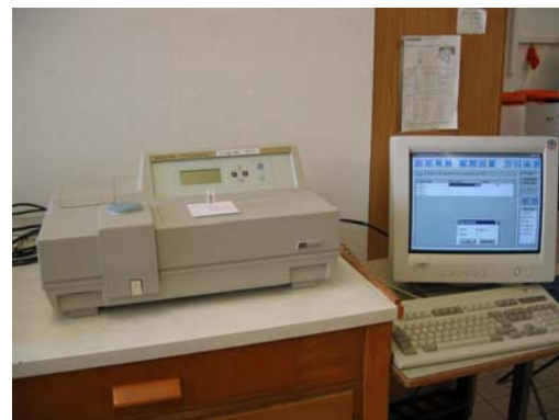
Spektrometr typu UV/VIS: wykrywanie zawartości chromianu zgodnie z normami serii DIN
