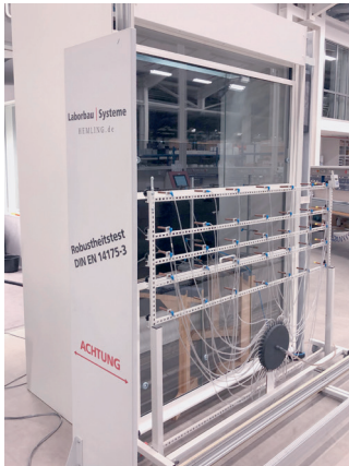
Essai effectué sur une sorbonne
