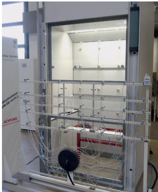
Prüfung eines Laborabzuges
