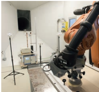
Cabine d'essai robotisée
