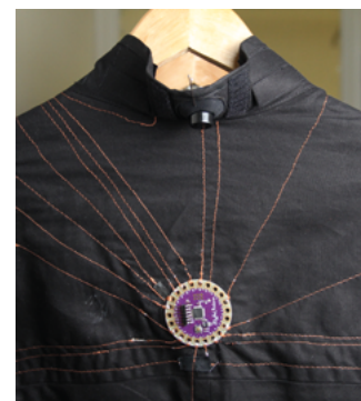
Veste intelligente avec microprocesseur
